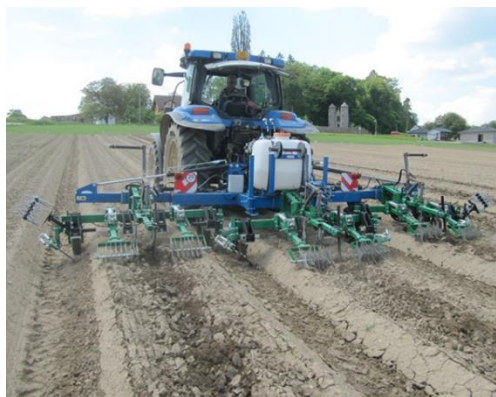
Obr. 6: Rozrušení krusty na povrchu hrůbků s obnovou důlků v nekolejové brázdě
