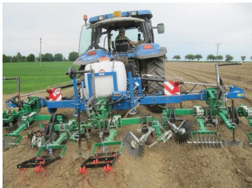
Obr.19: Mechanická likvidace vzcházejících plevelů před vzejitím brambor
