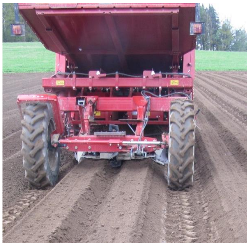
Obr. 3: Rozšířené hrůbky s miskovitým tvarem na horní straně a vyměščená nekolejová brázda
