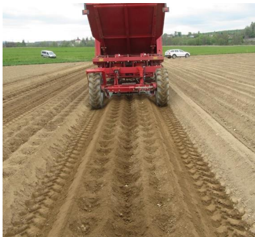
Obr. 4: Inovovaný tvar hrůbků a nekolejové brázdy s důlky a hrázkami ve srovnání s konvenčním hrůbkem (vpravo)
