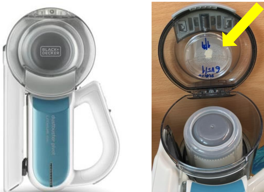
Obr. 1: Přenosný akumulátorový vysavač Black&Decker PV1020L-QW, upevnění Petriho misky pro odběr mikromycetů (vpravo)
