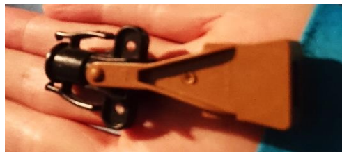
Obr. 14 Tryska směrového zadešťovače. Foto A. Bilavčík.
