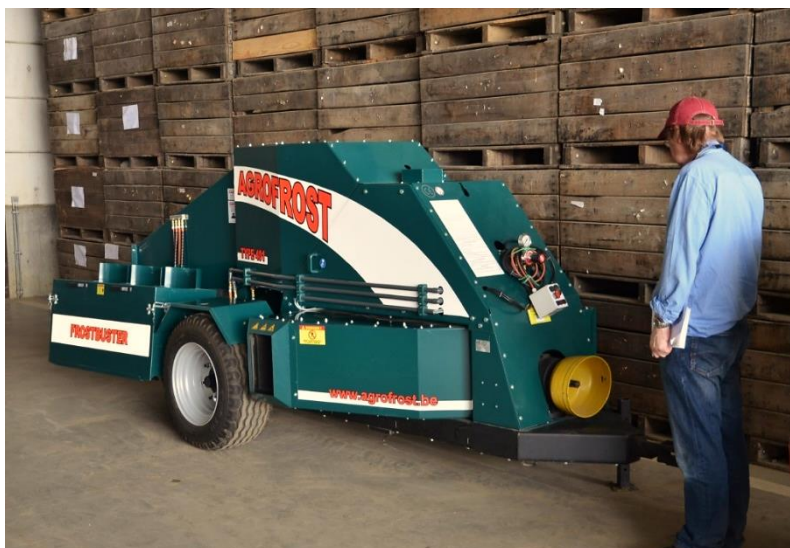
Obr. 9 Tažený plynový teplovzdušný fukar Frostbuster. Před nápravou je patrný obdélníkový obrys výdechu teplého vzduchu. Za nápravou jsou kapsy na umístění zásobních lahví. Foto L. Laňar.
