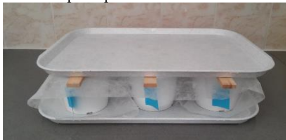
Obrázek S3. Květníky, ve kterých je zemina, jsou přikryty bílou netkanou textilií, aby byla eliminována křížová kontaminace, ale aby byl umožněn přístup vzduchu
