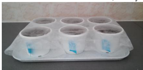
Obrázek S3. Květníky, ve kterých je zemina, jsou přikryty bílou netkanou textilií, aby byla eliminována křížová kontaminace, ale aby byl umožněn přístup vzduchu
