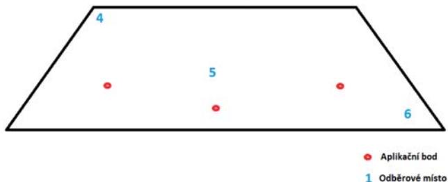
Obrázek 3.2.2: Schematické znázornění ošetřované hráně dřeva s vyznačenými aplikačním a monitorovacími body.
