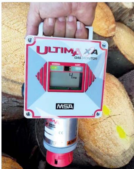
Obrázek 2.3.6: Měřicí přístroj MSA Ultima XA.
