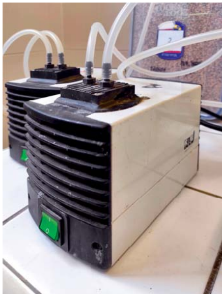
Obrázek 2.3.8: Vzduchomembránové čerpadlo N86KT.16 pro odběr vzorků z ošetřované hráně.
