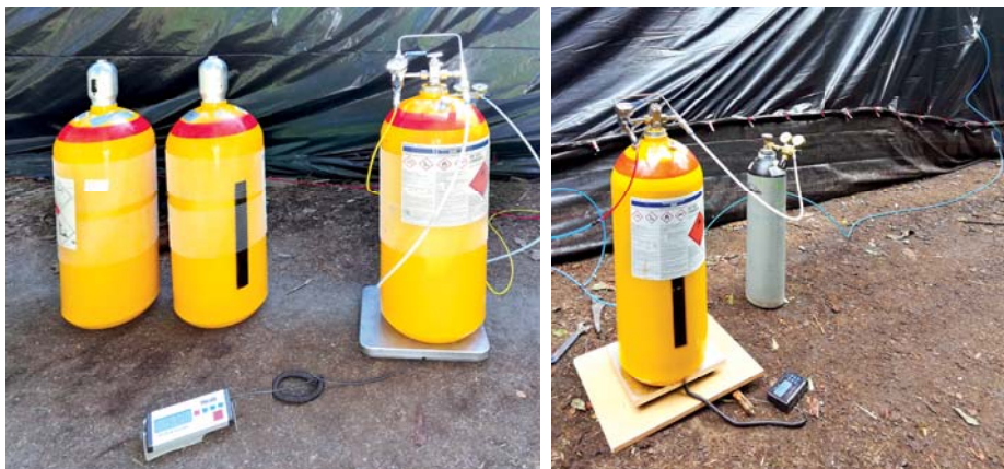
Obrázek 2.3.3: Kompletní aplikační sestava s tlakovými lahvemi pro aplikaci přípravku EDN®
