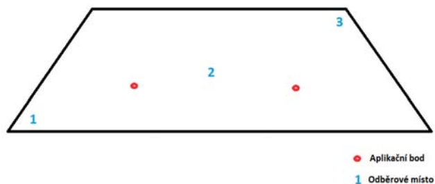
Obrázek 3.2.1: Schematické znázornění ošetřované hráně dřeva s vyznačenými aplikačním a monitorovacími body.
