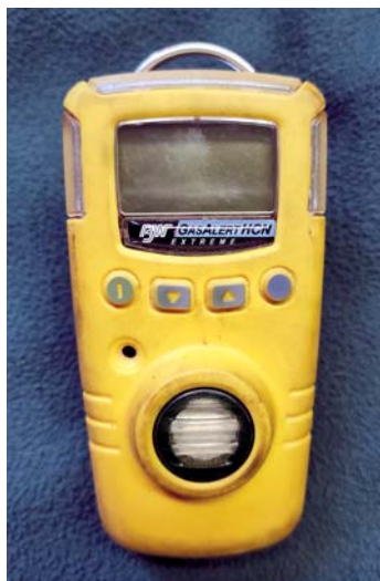
Obrázek 2.3.7: Měřicí přístroj GasAlert HCN Extreme.
