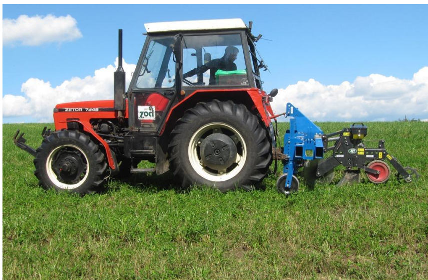
Obr. 4: Stroj Terrier na podpovrchovou aplikaci rodenticidů na hraboše
