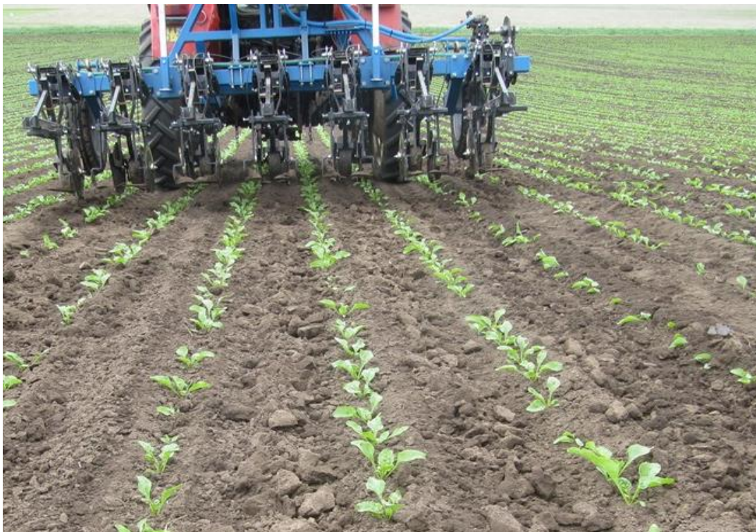
Obr. 1: Testování vhodných nástrojů pro plečkování cukrovky (foto: Růžek)
