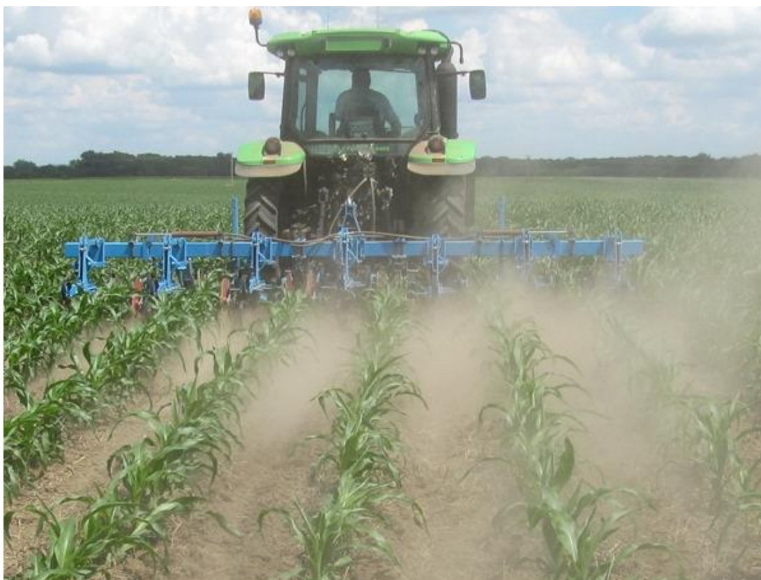
Obr. 2: Mělké plečkování kukuřice s poškozením povrchové struktury půdy (foto: Růžek)
