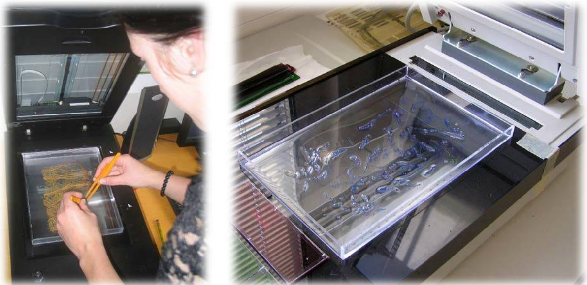
Obr. 25 Příprava neobarveného (vlevo) a obarveného (vpravo) vzorku kořenů ke skenování (foto T. Středa)
