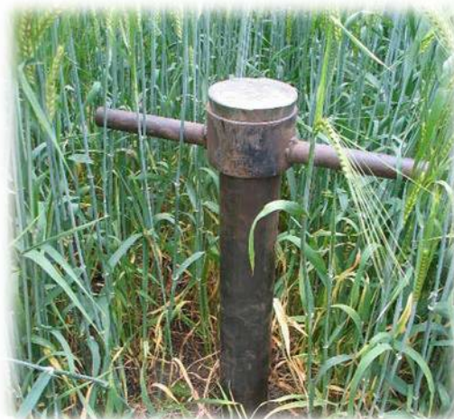
Obr. 13 Vzorkovač pro odběr vzorků půdy s kořenovým systémem (foto T. Středa)
