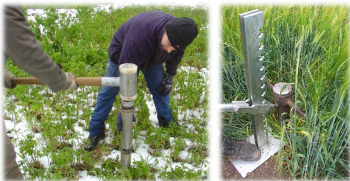
Obr. 11 Ruční odběr půdních válců soil-core metodou (foto T. Středa)
