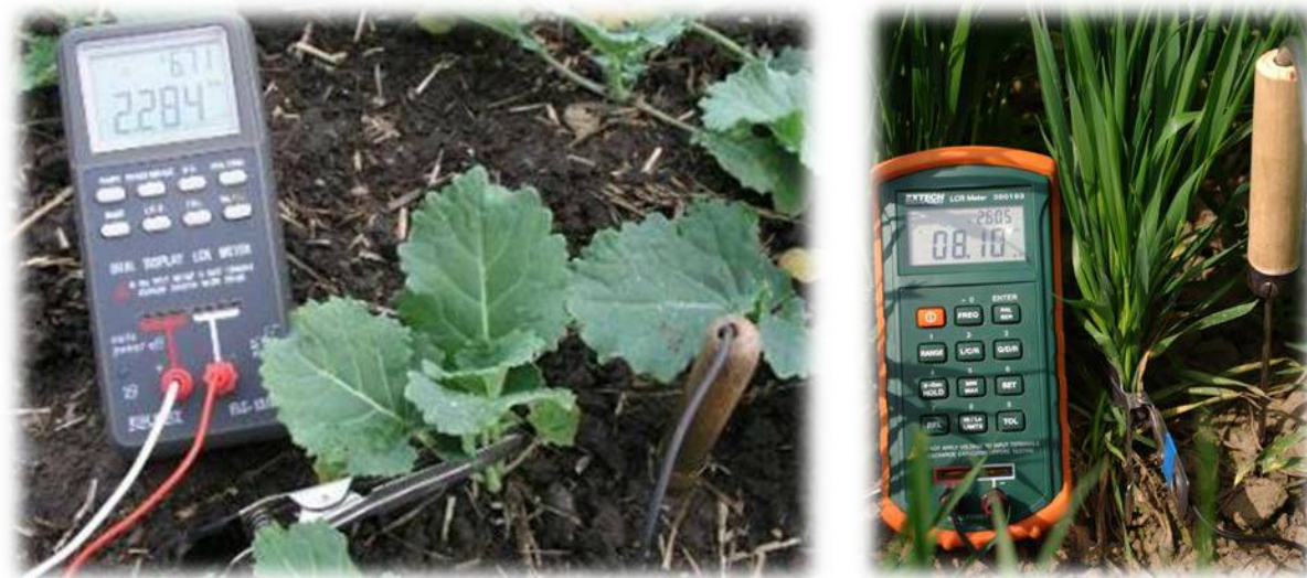
Obr. 2 Měření velikosti kořenů pomocí elektrické kapacity, vlevo řepky olejné (foto K. Ullmannová), vpravo ječmene setého (foto J. Kovárník)
