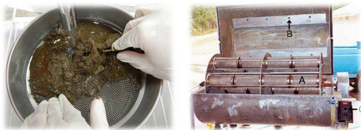
Obr. 18 Plavení vzorků kořenů ručně pod tekoucí vodou (vlevo; foto T. Středa), vpravo – s použitím automatického přístroje (převzato z Benjamin a Nielsen, 2004)
