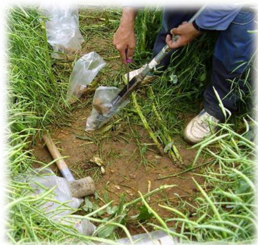
Obr. 28 Odběr vzorků kořenového systému půdním vrtákem (vlevo); vpravo – vzorek odebraný z hloubky 100 cm (foto J. Haberle)
