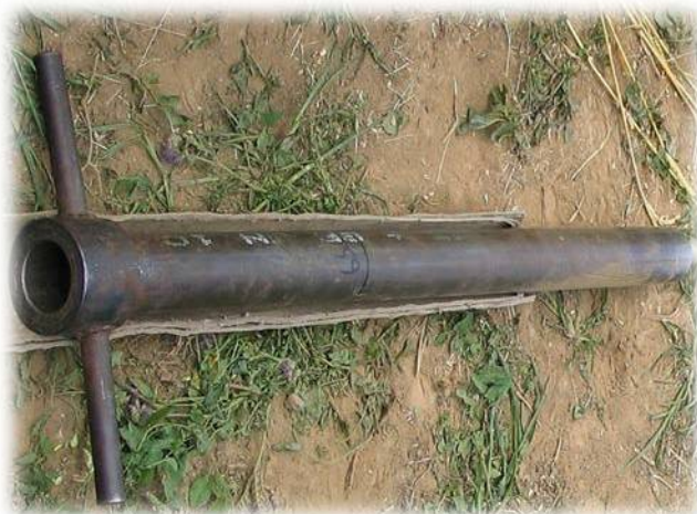
Obr. 13 Vzorkovač pro odběr vzorků půdy s kořenovým systémem (foto T. Středa)
