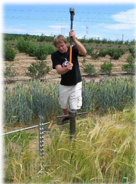
Obr. 14 Zavádění vzorkovače do půdy (foto T. Středa)
