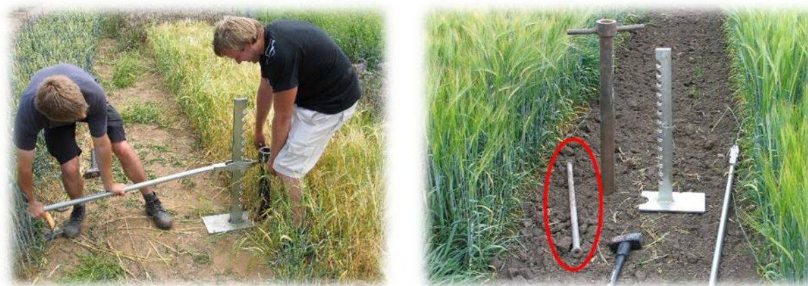
Obr. 15 Použití pákového mechanismu pro vysunutí vzorkovače z půdy (vlevo); razník pro vytlačení vzorku ze vzorkovače – červeně označeno na snímku vpravo (foto T. Středa)
