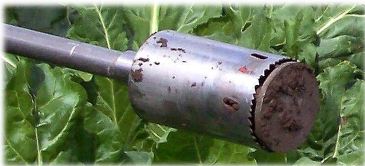
Obr. 12 Půdní vrták pro odběr vzorků půdy s kořenovým systémem (foto T. Středa)
