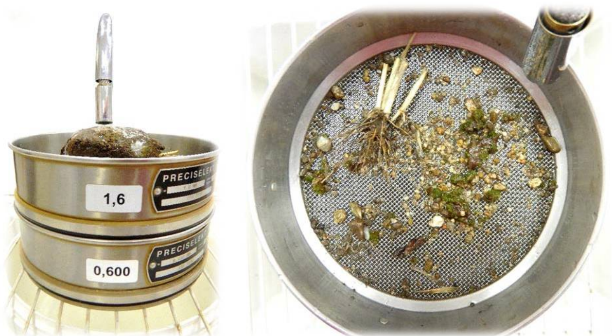
Obr. 19 Plavení na sítích (vlevo); vpravo – vyplavený vzorek (foto T. Středa)
