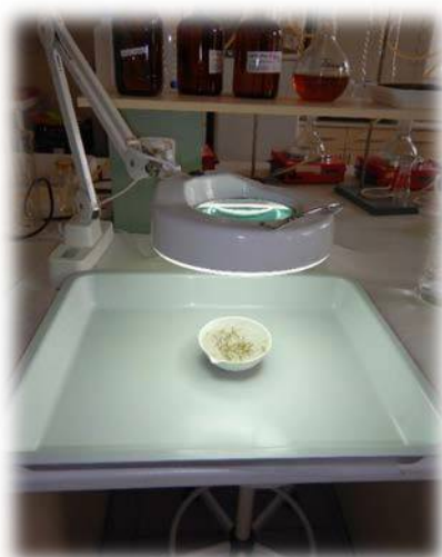
Obr. 21 Laboratorní lamp a s lupou (vlevo); vpravo – vzorek na sítích (foto T. Středa)
