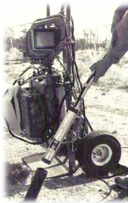
Obr. 10 Minirhizotron a pozorovací sada v polních podmínkách; schéma instalace minirhizotyonu (převzato ze Smit et al., 2000)
