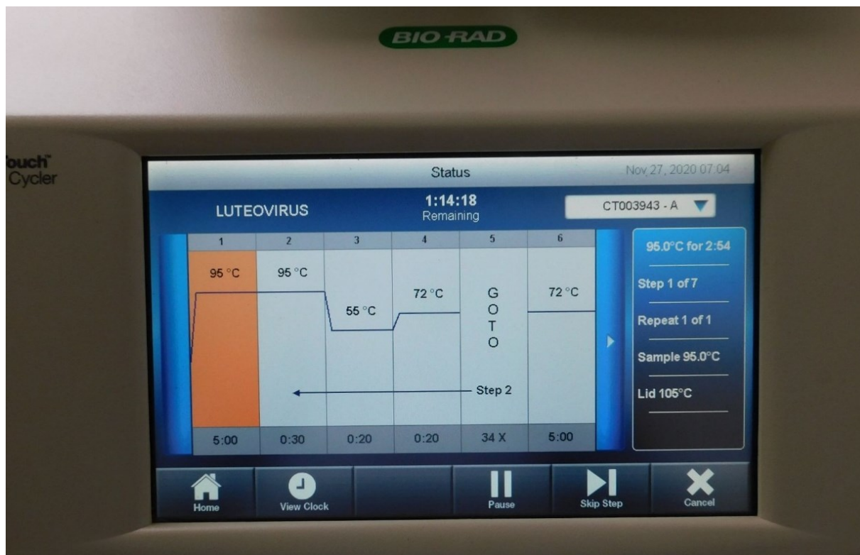
Obrázek 16: termocycler s nastaveným programem pro amplifikaci úseku genu viru žloutenky vodnice
