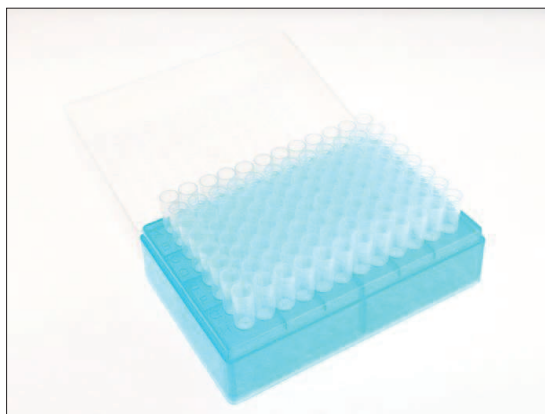
Obr. 2: Adaptér (rack) s 96 mikrozkušavkami (1,2 ml)
