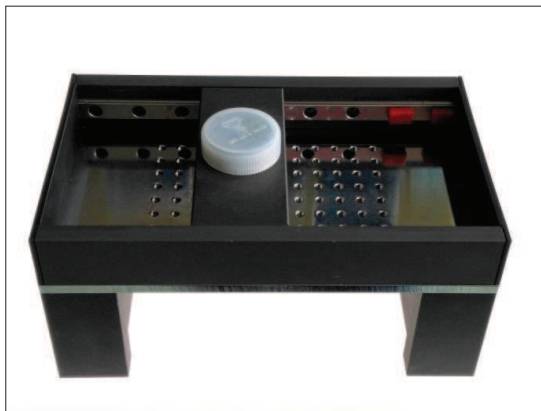
Obr. 1: Dávkovač na 96 kuliček o průměru kuličky 3 mm
