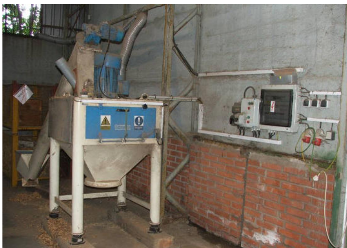
Obr. 10: Kladívkový šrotovník ŠV 15 (VÚZT)
