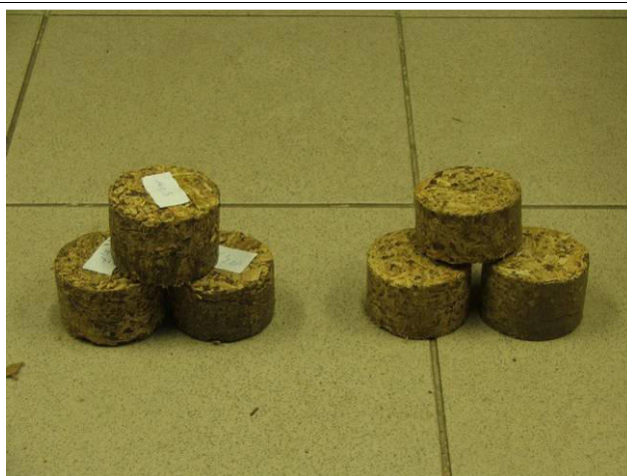
Obr. 9: Topné brikety vytvořené ze štěpky z prořezu jabloní
