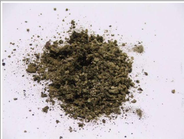
Obr. 21: Mírně spečený popel z pelet z jabloní
