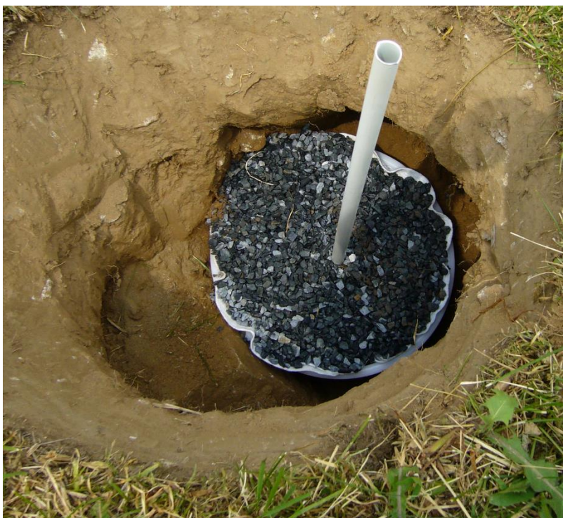
Obrázek 3. Drenážní lyzimetr použitý k jímání půdních vod.
