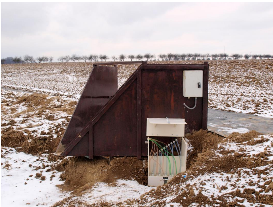
Obrázek 4. Měrný žlab pro měření a vzorkování povrchového odtoku
