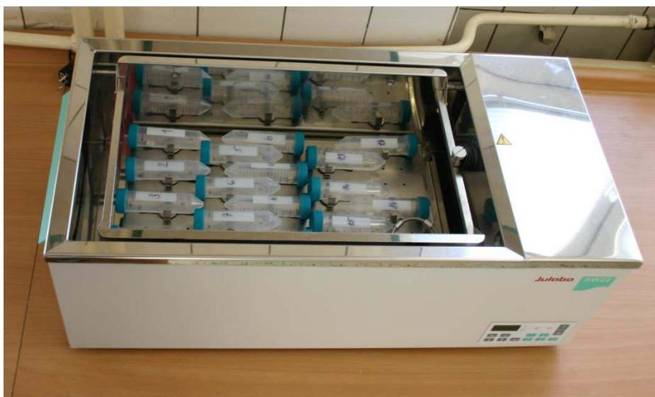
Obr. 3: Vodní lázeň s třepací vložkou s nastavitelnou frekvencí třepání a nastavitelnou teplotou
