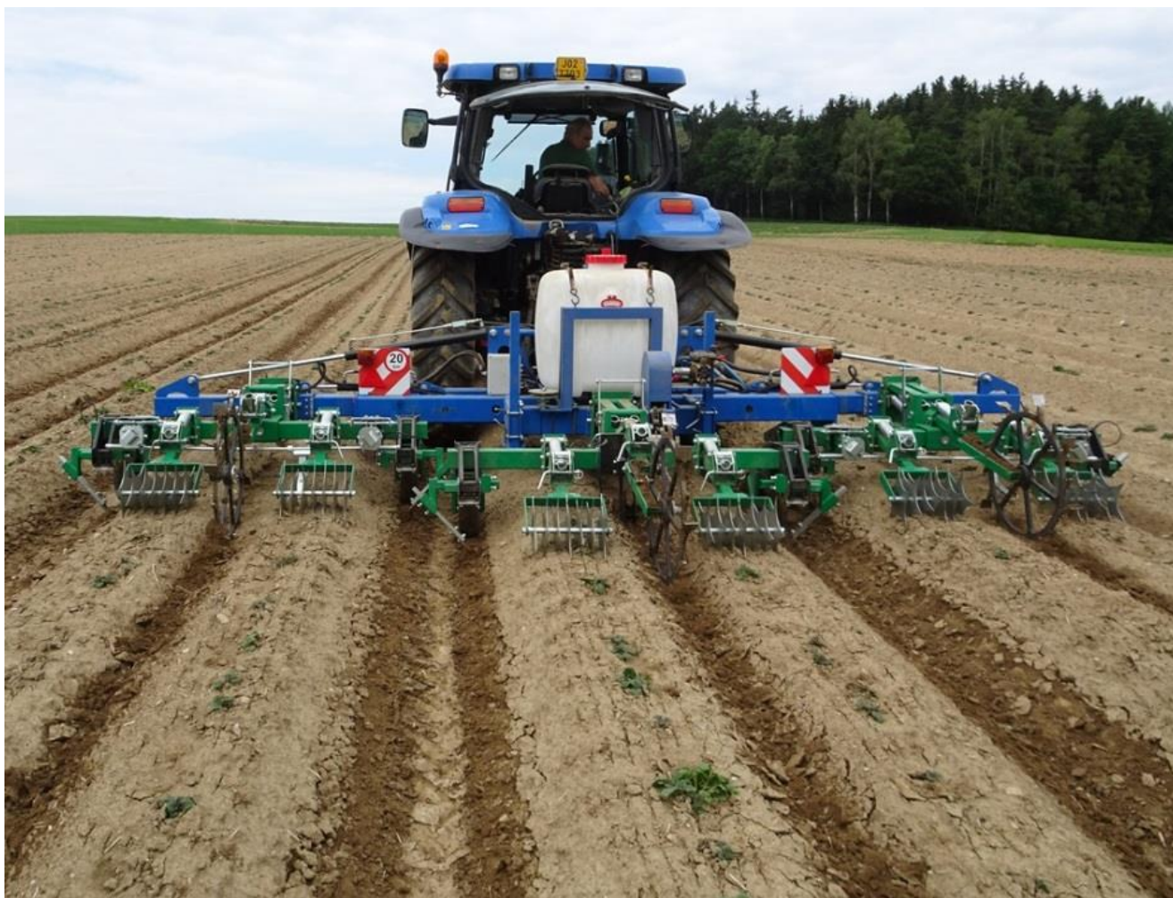
Obr. 9: Kypřič hrůbků brambor s přihnojením na začátku vzcházení
